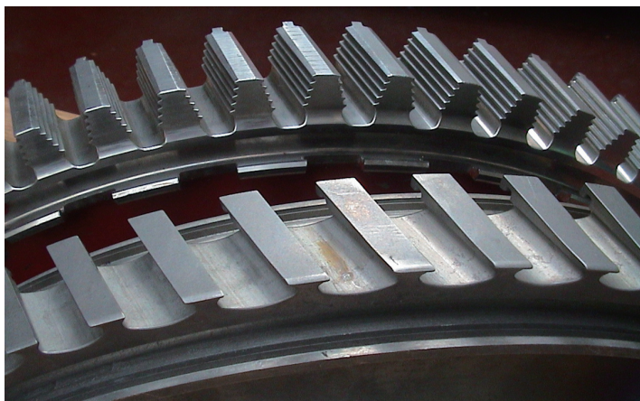
图2 慢走丝线切割加工实例
