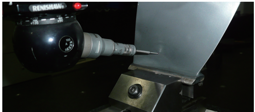
图3 叶片的三坐标检测
