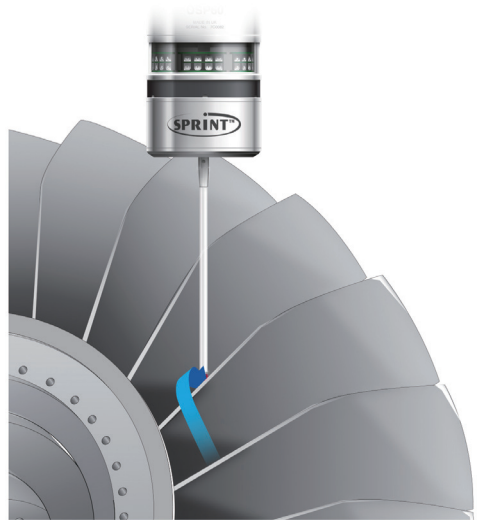
图5 整体叶盘叶片测量
