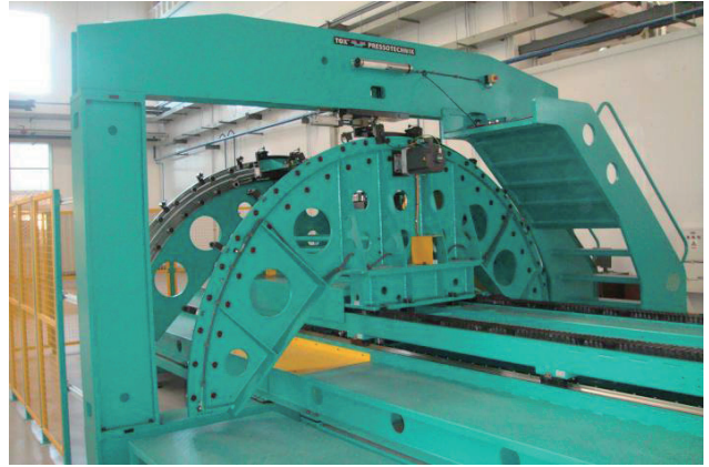
图4 壁板半自动化铆接设备
