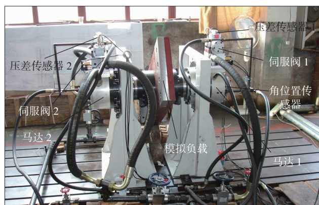
图3 实际配置的双马达同步控制系统 Fig.3 Actual configuration of DMSC
