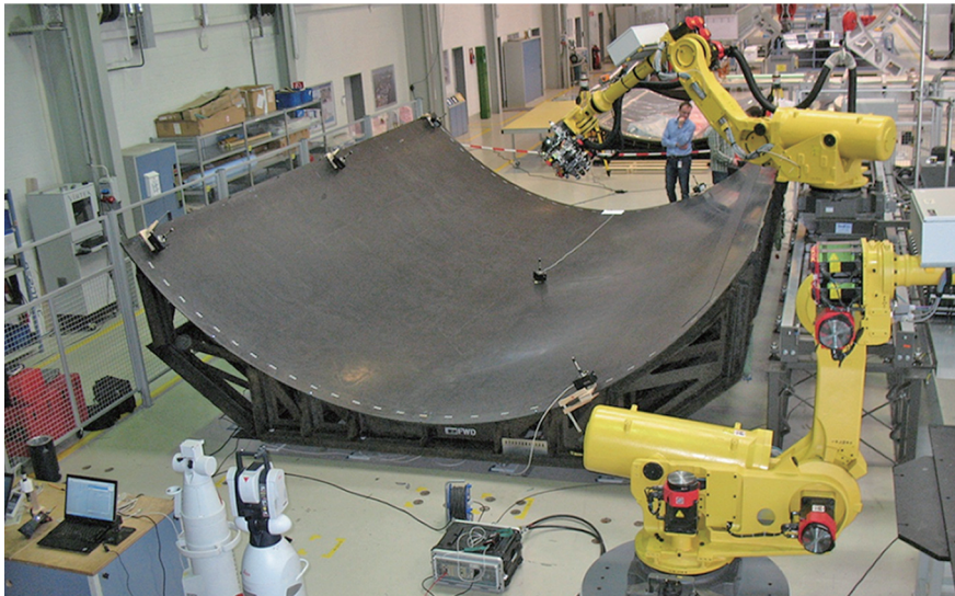
图4 Leica绝对激光跟踪仪引导机器人完成自动化装配
