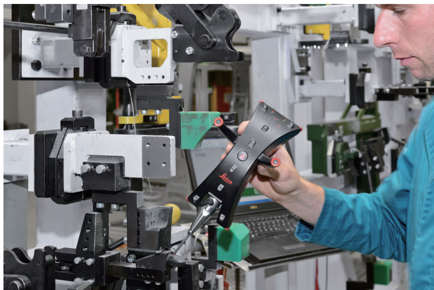
图1 Leica T-Probe手持式测量有效解决隐藏点和内部特征检测难题
