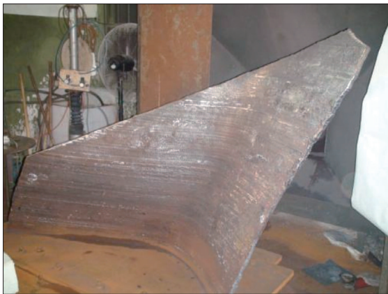
图3 张等成形的大型飞机蒙皮零件
