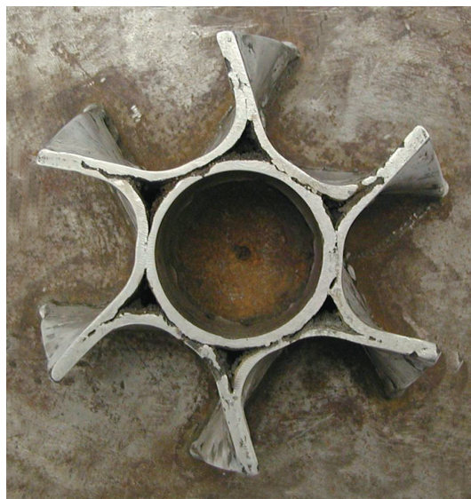
图1 采用熔积-铣削成形技术一次性成形的双螺旋整体叶轮
