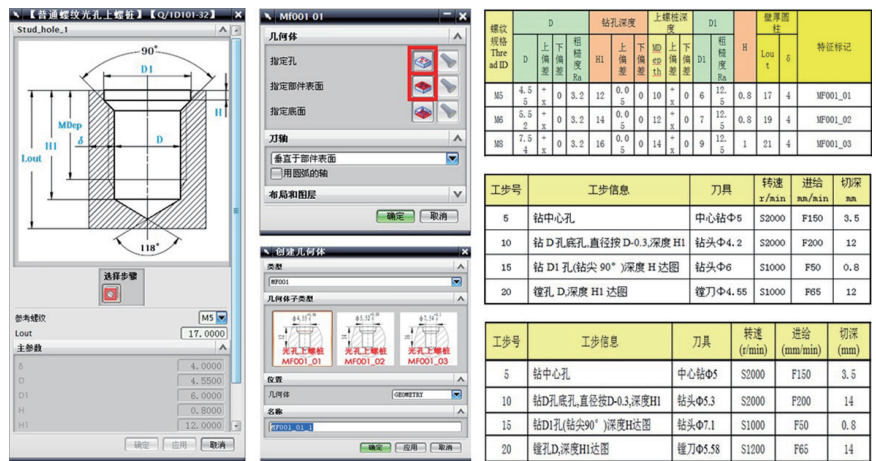
图3 面向制造的设计特征模块界面
