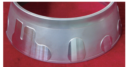
(a)外壁凸台
