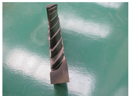
图7 叶盘叶型套料电解加工初成形
