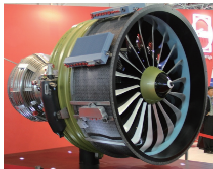
图3 LEAP发动机复合材料机匣和复合材料叶片
