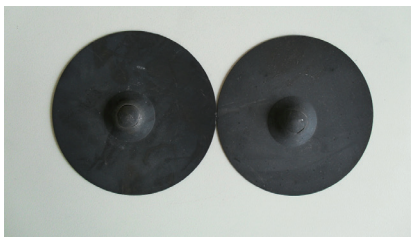
图3 高温埃里克森杯突试验变形试样
