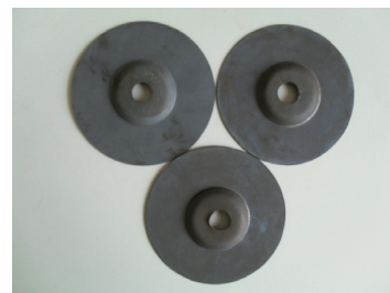
图9 高温扩孔变形试样
