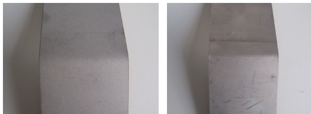
(a)MGH956 45°弯曲试样 (b)TA12 45°弯曲试样
