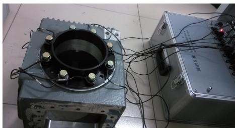
图8 螺栓组拧紧试验实物图
