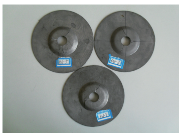
图8 室温扩孔变形试样
