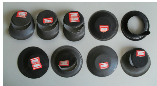
图6 高温拉深变形试样
