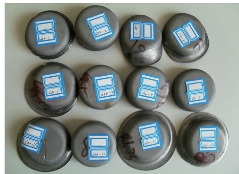
图5 室温拉深变形试样
