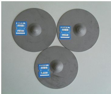
图2 室温埃里克森杯突试验变形试样
