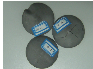
图14 室温锥杯变形试样
