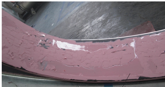
图10 风扇包容机匣组件机械解剖图
