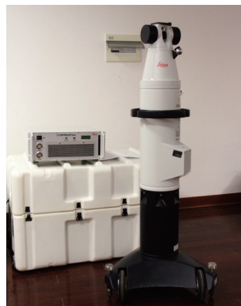
图2 激光跟踪仪测量系统组成
