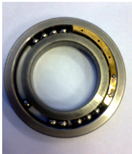
图1 失效轴承的外观形貌
