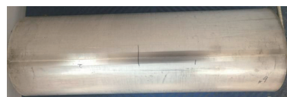
图3 钛合金薄壁结构件双光束激光焊接实物
