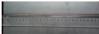
(d) 双光束激光焊背面焊缝成形
