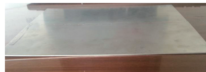
(c) 双光束激光焊纵向挠曲变形
