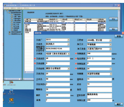
图3 切削参数库的数据项及操作界面 Fig.3 Data items and operation interface of cutting parameter database
