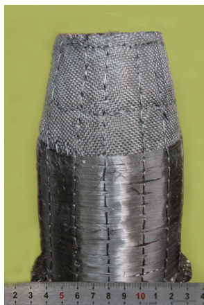
图4 纤维缠绕定型工艺制备的预成形体(试样3)
