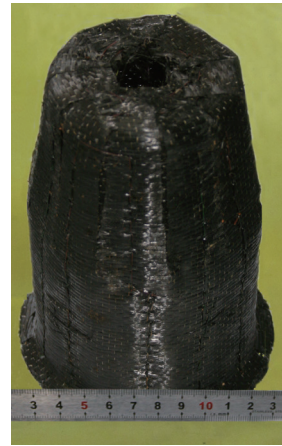
图2 0°/90° 等比例铺放工艺制备的预成形体 (试样1)
