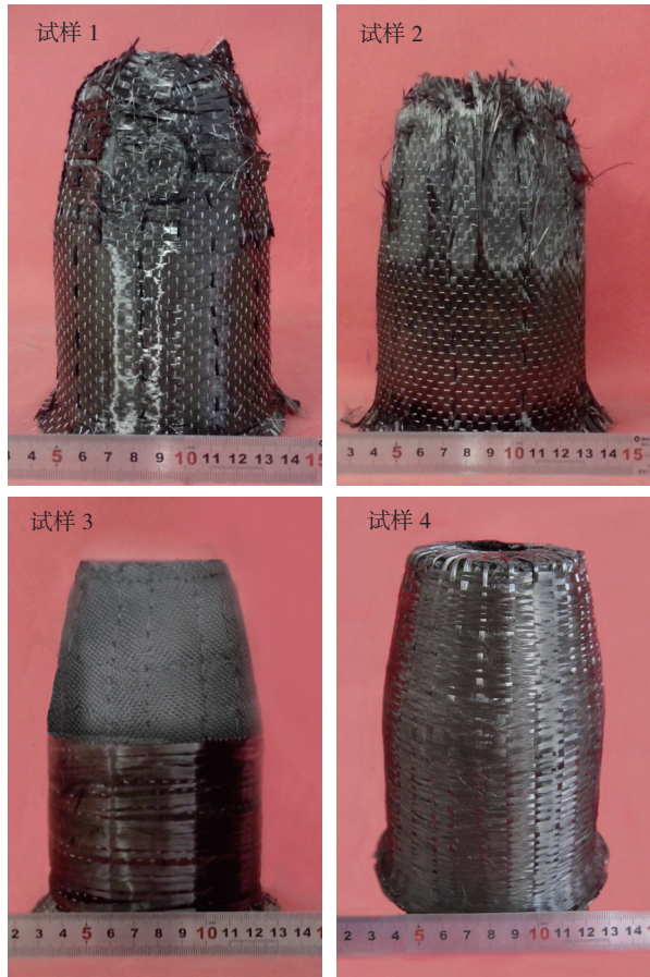
图6 试样尺寸稳定性测试结果
