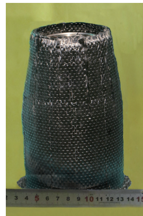
图3 0°/90° 不等比例铺放工艺制备的预成形体 (试样2)
