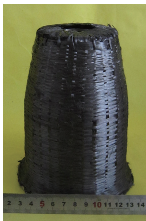
图5 纤维编织加固工艺制备的预成形体(试样4)
