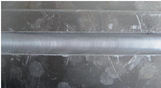
(a) 转速 1000 r/min, 焊速 400mm/min
