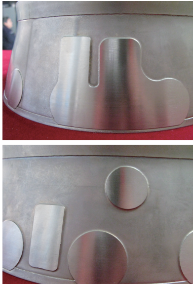
图5 照相电解成形的复杂表面形状
