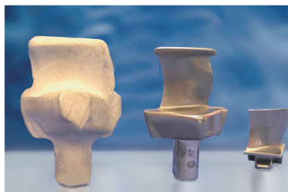
图10 钛铝金属间化合物叶片精密电解加工(德国)
