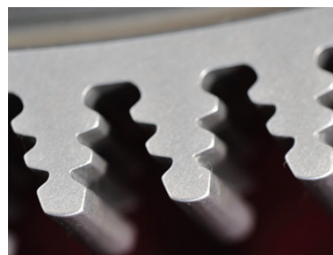
(b) 榫槽边缘机械自动倒圆、抛光形貌
