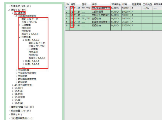
图5 维修BOM构建系统原型界面
