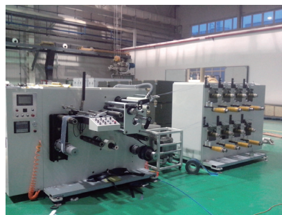
图10 碳纤维预浸料自动分切复卷机构
