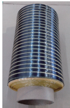
图15 预浸料PE下覆膜 Fig.15 Under-bottom PE film prepreg
