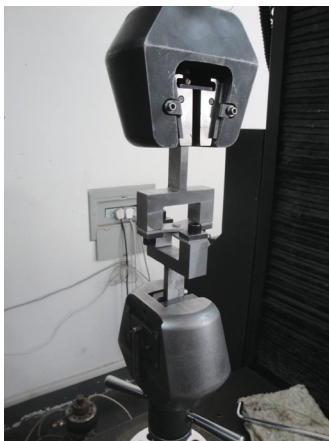
图7 拉脱试验件及工装
