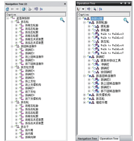
图11 拆卸工艺树、操作树
