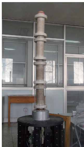
图3 8自由度蛇形臂机器人
