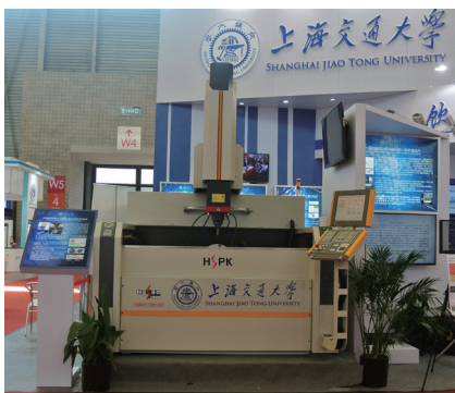
图4 国产六轴电火花成形机及涡轮盘加工
