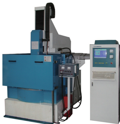
图5 蜂窝环数控高效电火花磨削专用设备
