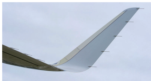
图9 A320和A320NEO的鲨鳍翼梢小翼 Fig.9 Sharklets on A320&A320NEO
