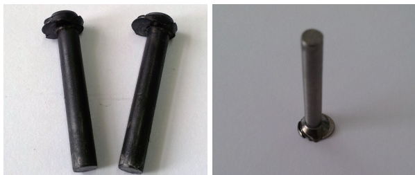
(a) 毛坯冷锻开裂破坏 (b) 毛坯折叠缺陷
