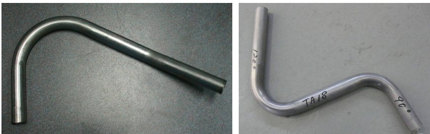
图3 实际采购管材弯曲试验
