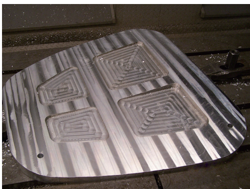
图12 模具曲面的加工效果
