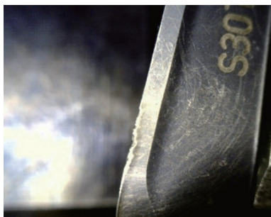
图9 Sandvik S30T逐渐崩刃
