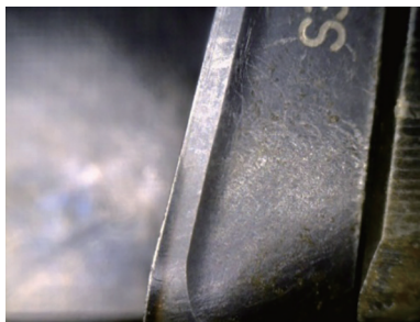
图8 Sandvik S30T基体颜色出现
