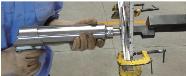
图7 铆枪及铆接试验件
