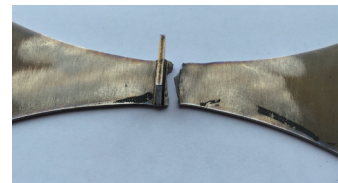
图4 焊缝区断裂位置
