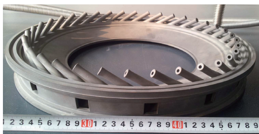
图5 粉末冶金法成型的 Ti-22Al-24Nb-0.5Mo 零件
