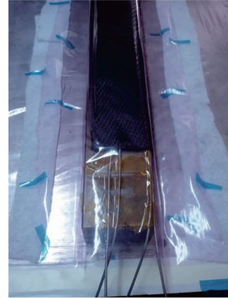
图4 L型碳纤维中光栅温度、应变传感器布置实物图
