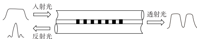
图1 光纤光栅传感系统的基本原理图
