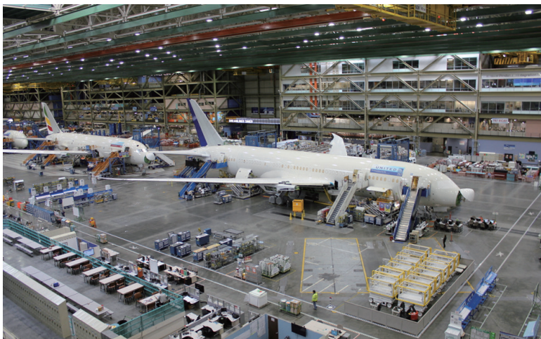
图1 波音脉动式总装配线
