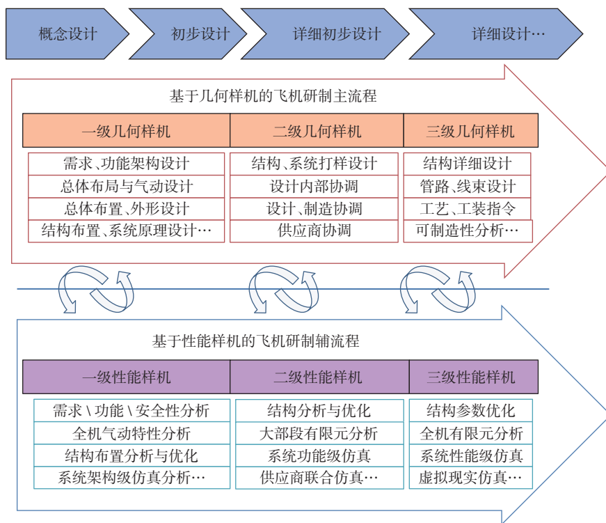
图3 飞机设计中的两类三级样机
