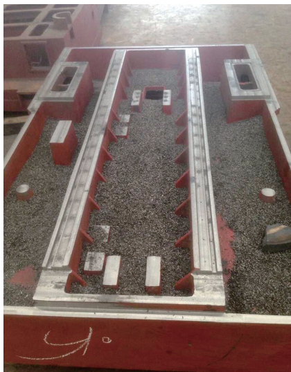
图8 加工后的大型铸件
