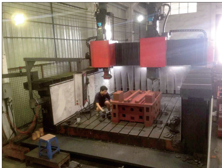
图7 龙门加工中心机床实物图
