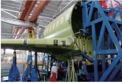
图5 翼身自动对接试验
