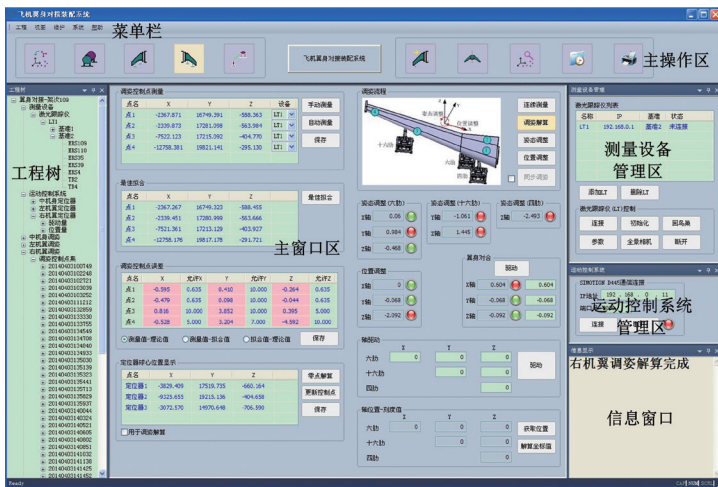
图4 大部件自动对接集成控制软件
