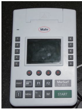
图3 MarSurf M300C表面粗糙度仪
