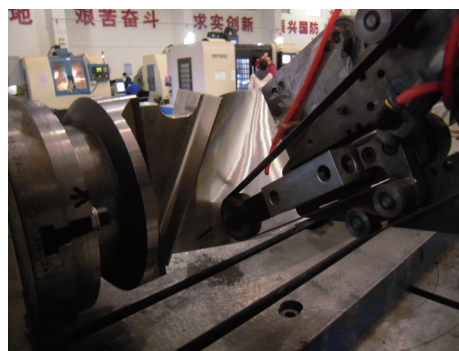
图2 砂带抛光工艺试验
