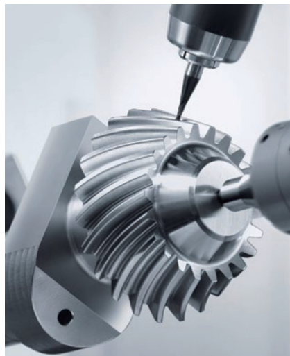
图2 一次装夹实现齿轮全套加工的车铣加工中心
