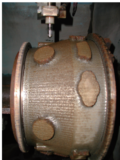
图6 高效放电铣机床加工的机匣
