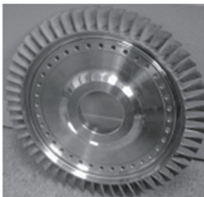
图5 “Blue-Arc” 的加工机理及加工的叶盘零件
