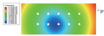
图7 铆接完成后铆接件位移云图
