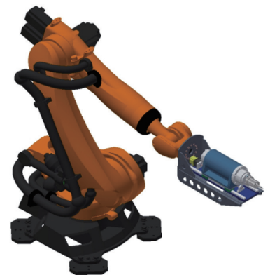
(b) 安装于机器人的自动化超声辅助制孔系统
