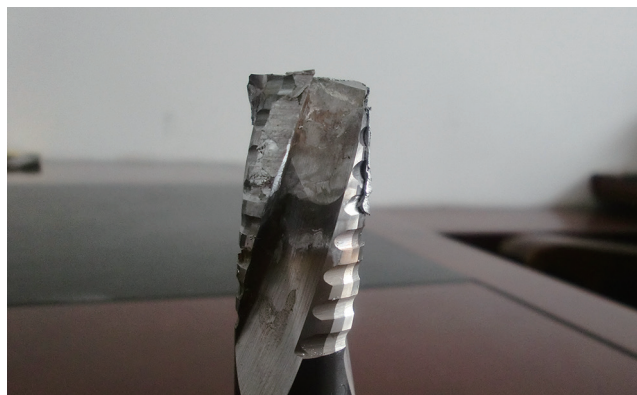
(a) 发生严重粘接的刀具
