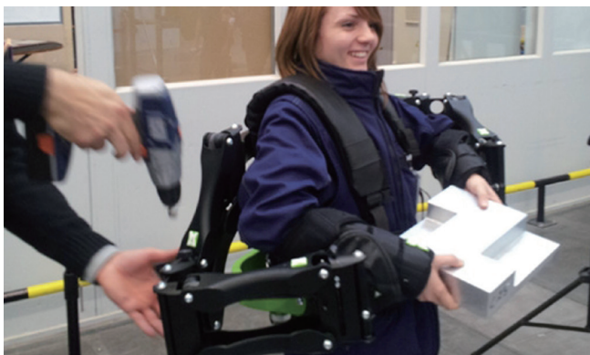
图2 机械化外骨骼 Fig.2 Mechanical exoskeleton
