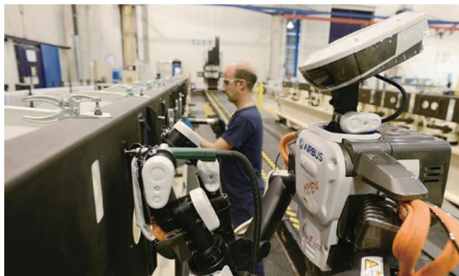
图1 双臂仿人机器人 Fig.1 2-Arm humanoid robot
