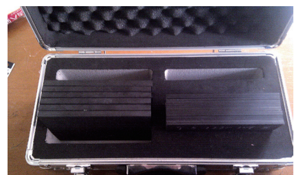
图3 上飞公司研制的孔隙率对比试块 Fig.3 Porosity references of SAMC
