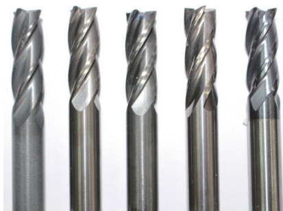
图4 整体式陶瓷立铣刀与硬质合金立铣刀 (由左至右分别为 \text{Si}_3\text{N}_4 、 \text{Ti}(\text{C},\text{N}) 、 \text{SG}_4 、 \text{LT55} 和硬质合金刀具)
