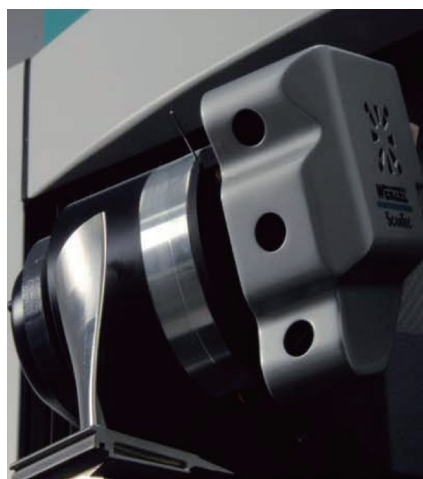
图12 双眼三角测距激光测头涡轮叶片扫描测量
