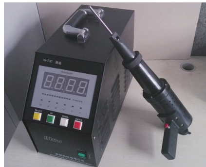
图3 便携式超声波喷丸设备 Fig.3 Portable USP device
