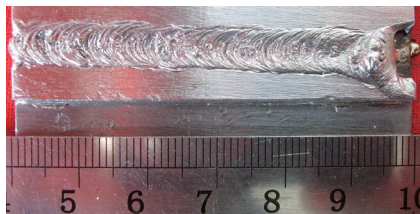
(b) 搭接接头表面形貌
